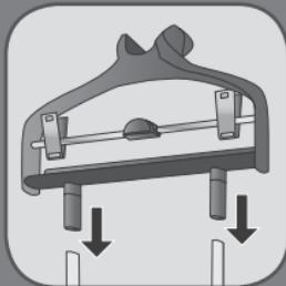
**ES** Introduzca completamente la percha en posición vertical en la parte superior de la barra.
